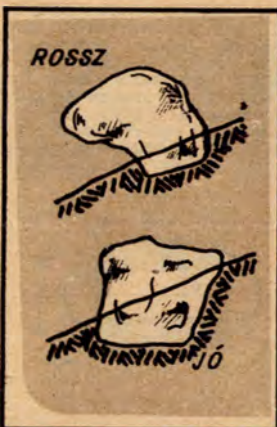
A szikla helytelen, illetve helyes beágyazása
