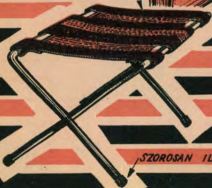
EGY LÁB KITERÍTETT HOSSZA: 120 cm φ 10x2-ES ACÉL-V.
